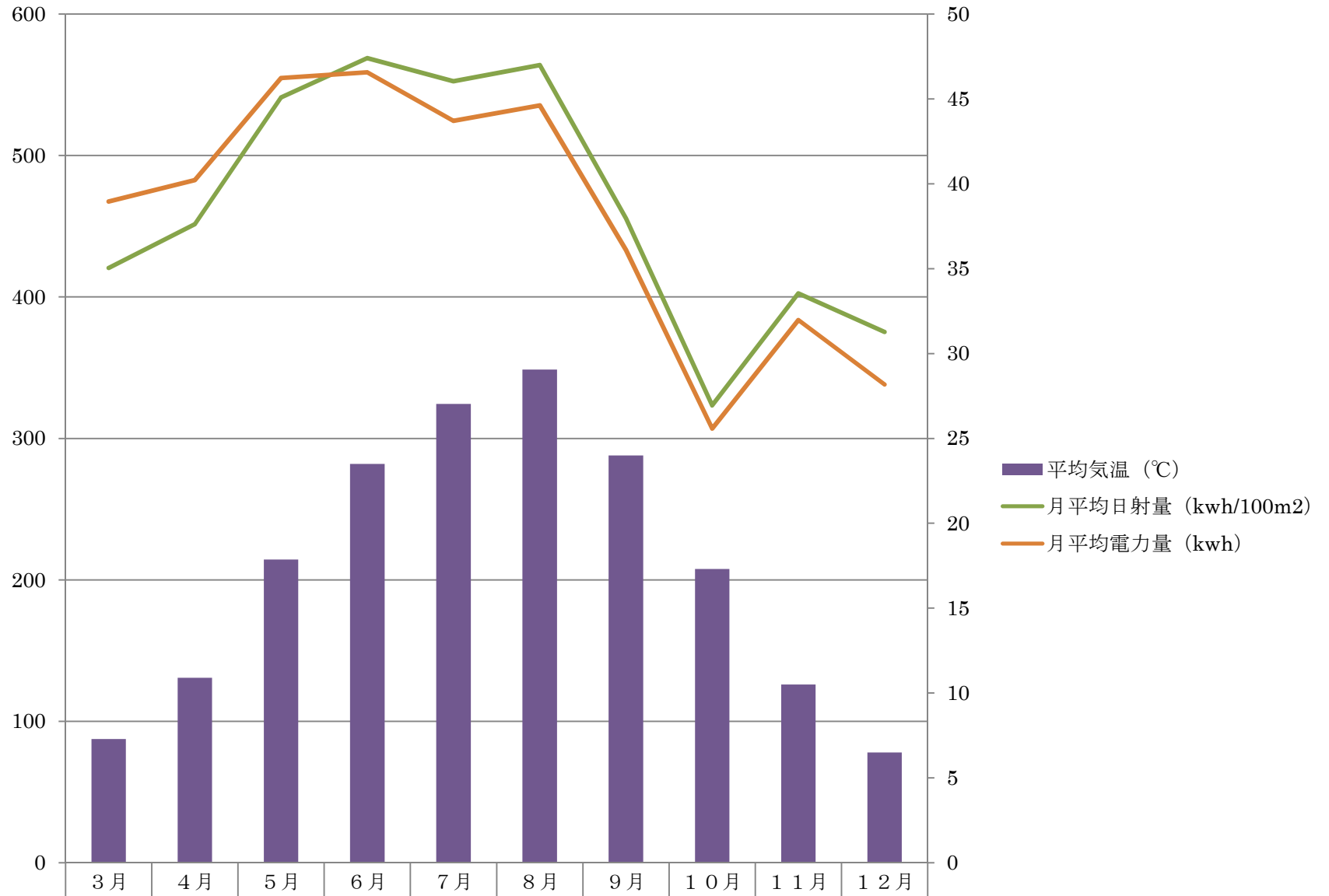
平成22年あい愛プラザ太陽光発電設備発電状況
