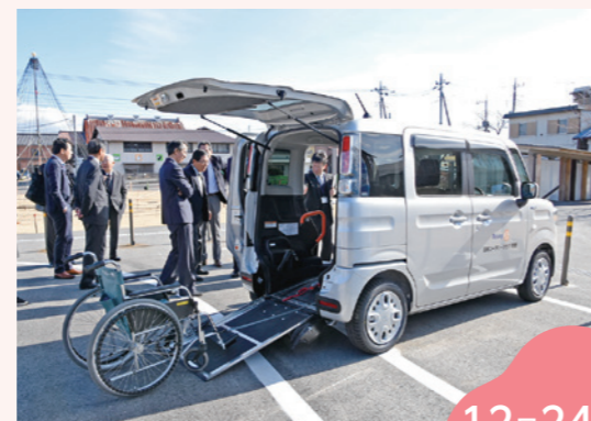
車両後部の緩やかなスロープから車いすのまま乗車が可能
